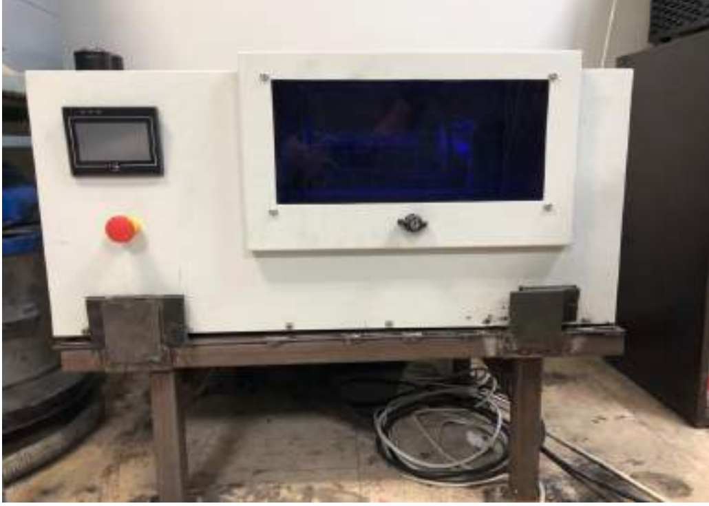
Görsel 1. Pehlivan – Uyaroglu kaotik sistemi entegre edilen yeni nesil bilyeli öğütücü
