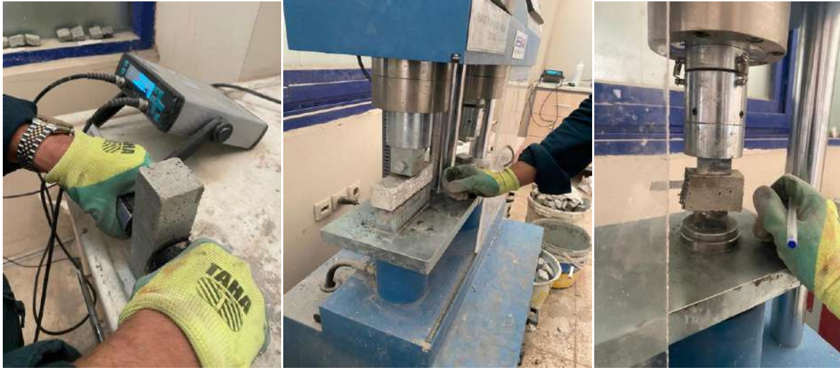
Görsel 3: UPV, Eğilme ve Basınç dayanımı deneyleri
