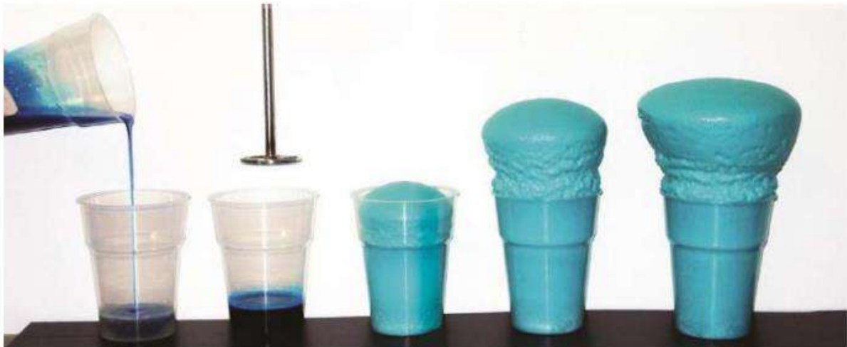
Görsel 1. Standart laboratuvar kabında poliüretan köpük üretim aşamaları ( http://www.erapol.com.au/technical/foam/properties/ )
