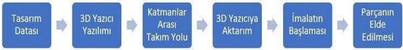
Şekil 1. FDM yazıcılarıdaki üretim süreci
