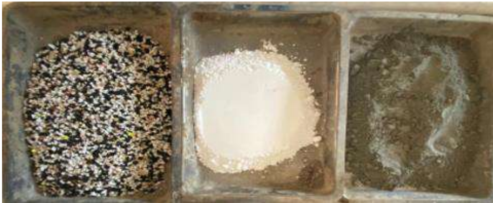
Görsel 1: Atık poliüretan lastik agrega, Mikronize kalsit ve Elazığ ferrokrom cürufu
