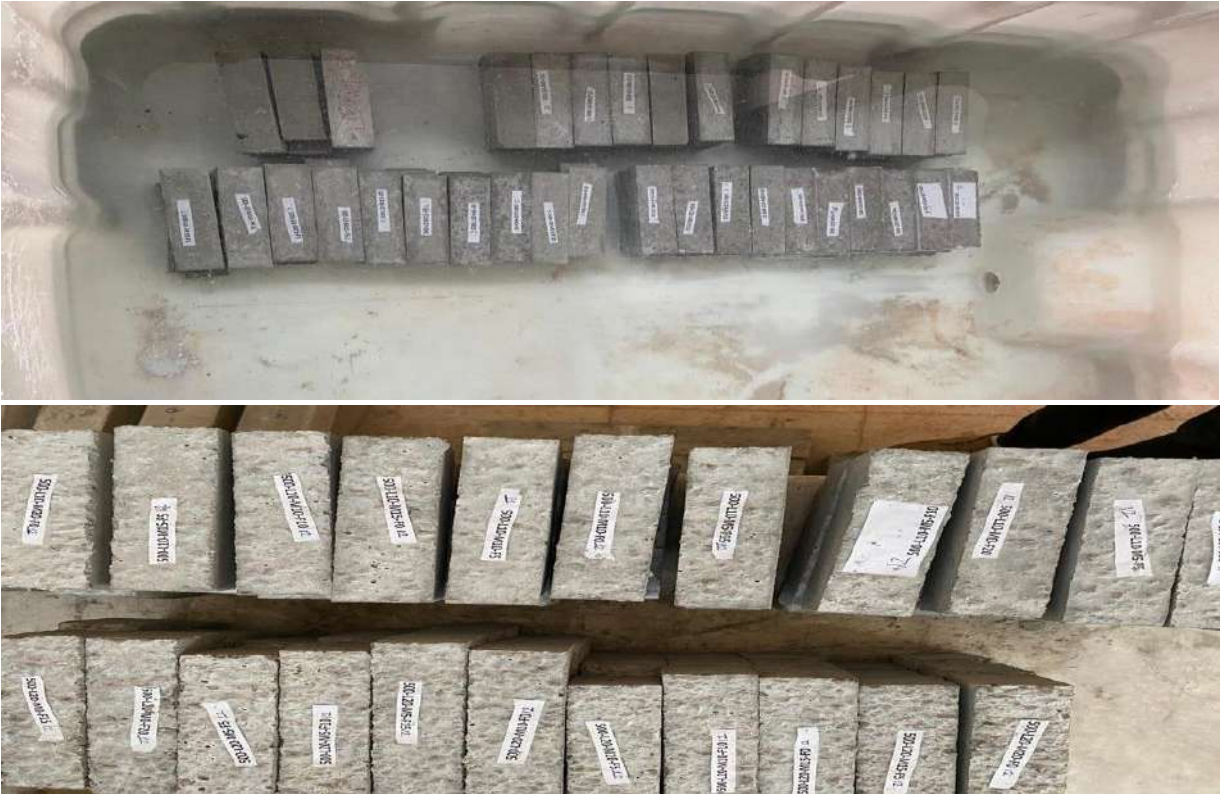
Görsel 2: Su ve hava küründe bekleyen numuneler
