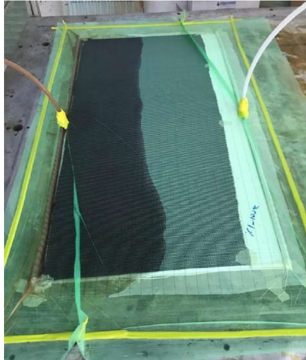
Şekil 2. Kompozit levha üretiminde matris karışımının ilerlemesi
